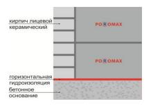
Гидроизоляция основания — наиболее важная технологическая операция, поскольку исправить дефекты гидроизоляции в готовом здании практически невозможно. Гидроизоляция основания должна быть выполнена по всему периметру на толщину каменной стены из качественных сертифицированных материалов и находиться выше уровня отмостки здания.
