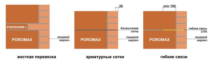
Глубина заделки одиночных связей в растворный шов должна составлять не менее **100 мм** в основном слое из камня POROMAX, в облицовочном слое из кирпича 1NF – **90 мм**, 0,7NF – **60 мм**. Связи должны отстоять от вертикальных растворных швов не менее чем на **20 мм**.
