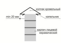
**Кровельное водоотведение** — водосточная система должна быть правильно спроектирована и смонтирована и исключать проникновение атмосферной влаги в стены. Особое внимание необходимо уделять защите от тающего снега и внутренним углам здания.
