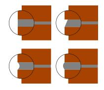
Растворные швы — шов должен быть выполнен качественно, без провалов и раковин, и надежно уплотнен. Шов не должен углубляться более чем на 2 мм от лицевой поверхности кирпича и обеспечивать беспрепятственное стекание дождевой воды по стене. Рекомендуемая толщина горизонтального шва - 10 — 12 мм, вертикального - 10 мм. Дождевая вода, стекающая по стене, не приводит к высолам, поскольку быстро испаряется и не проникает в кладку.
